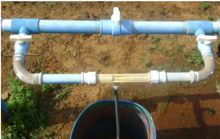
Figura 11. Detalhe do injetor de fertilizantes
